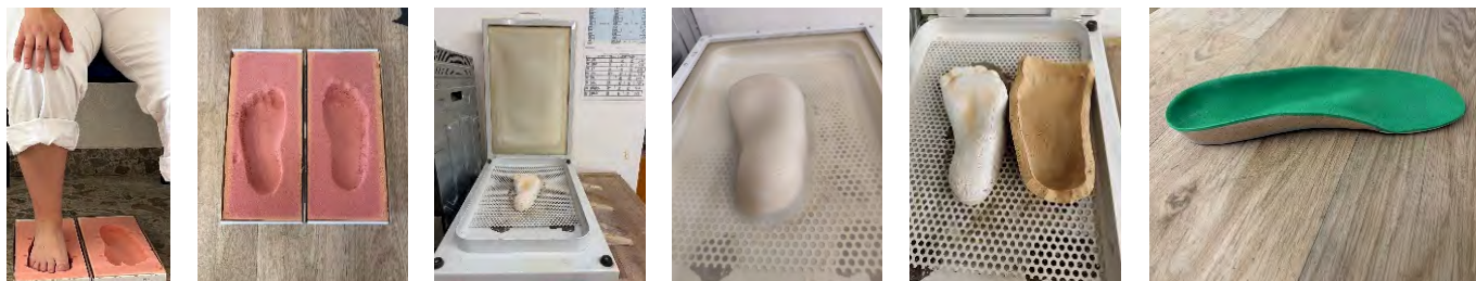
Obr. 2 a–f: Způsob výroby ortopedické vložky na základě sádrového odlitku, pomocí vakuového lisu
